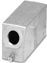
Tüllengehäuse B24, für Längsbügel, Material: Aluminiumdruckguss, seewasserbeständig, Kabelabgänge: 1, seitlich, 1x M25, Höhe: 60 mm, Kabelverschraubung: ohne, Standard
