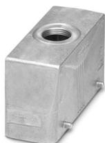
Tüllengehäuse B24, für Querbügel, Material: Aluminiumdruckguss, seewasserbeständig, Kabelabgänge: 1, gerade, 1x Pg29, Höhe: 60 mm, Kabelverschraubung: ohne, Standard
