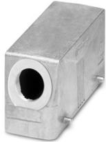
Tüllengehäuse B24, für Querbügel, Material: Aluminiumdruckguss, seewasserbeständig, Kabelabgänge: 1, seitlich, 1x Pg16, Höhe: 60 mm, Kabelverschraubung: ohne, Standard
