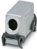
Tüllengehäuse B24, mit Querbügel, Material: Aluminiumdruckguss, seewasserbeständig, Kabelabgänge: 1, seitlich, 1x Pg21, Höhe: 76 mm, Kabelverschraubung: ohne, Standard
