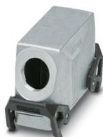
Tüllengehäuse B24, mit Querbügel, Material: Aluminiumdruckguss, seewasserbeständig, Kabelabgänge: 1, seitlich, 1x M32, Höhe: 76 mm, Kabelverschraubung: ohne, Standard
