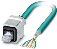
Konfektioniertes Ethernet-Kabel, geschirmt, 4-paarig, AWG 26 schleppkettentauglich (19-drähtig), RAL 5021 (wasserblau), RJ45-Stecker/IP67 Push-Pull Metallgehäuse auf freies Leitungsende, Line, Länge 2 m
