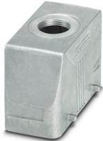
Tüllengehäuse B16, für Querbügel, Material: Aluminiumdruckguss, seewasserbeständig, Kabelabgänge: 1, gerade, 1x M25, Höhe: 60 mm, Kabelverschraubung: ohne, Standard
