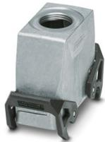
Tüllengehäuse B16, mit Querbügel, Material: Aluminiumdruckguss, seewasserbeständig, Kabelabgänge: 1, gerade, 1x Pg21, Höhe: 76 mm, Kabelverschraubung: ohne, Standard
