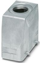
Tüllengehäuse B16, für Querbügel, Material: Aluminiumdruckguss, seewasserbeständig, Kabelabgänge: 1, gerade, 1x M32, Höhe: 76 mm, Kabelverschraubung: ohne, Standard
