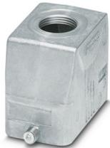
Tüllengehäuse B10, für Längsbügel, Material: Aluminiumdruckguss, seewasserbeständig, Kabelabgänge: 1, gerade, 1x M25, Höhe: 57 mm, Kabelverschraubung: ohne, Standard
