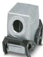
Tüllengehäuse B10, mit Querbügel, Material: Aluminiumdruckguss, seewasserbeständig, Kabelabgänge: 1, seitlich, 1x Pg29, Höhe: 72 mm, Kabelverschraubung: ohne, Standard
