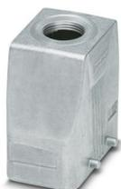
Tüllengehäuse B10, für Querbügel, Material: Aluminiumdruckguss, seewasserbeständig, Kabelabgänge: 1, gerade, 1x M32, Höhe: 72 mm, Kabelverschraubung: ohne, Standard
