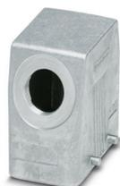
Tüllengehäuse B10, für Querbügel, Material: Aluminiumdruckguss, seewasserbeständig, Kabelabgänge: 1, seitlich, 1x M25, Höhe: 72 mm, Kabelverschraubung: ohne, Standard
