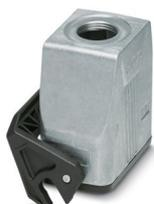
Kupplungsgehäuse B10, mit Längsbügel, Material: Aluminiumdruckguss, seewasserbeständig, Kabelabgänge: 1, gerade, 1x M25, Höhe: 73 mm, Kabelverschraubung: ohne, Standard
