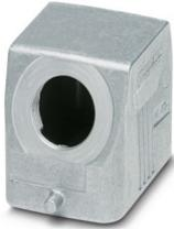
Tüllengehäuse B6, für Längsbügel, Material: Aluminiumdruckguss, seewasserbeständig, Kabelabgänge: 1, seitlich, 1x M25, Höhe: 52 mm, Kabelverschraubung: ohne, Standard
