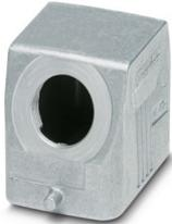
Tüllengehäuse B6, für Längsbügel, Material: Aluminiumdruckguss, seewasserbeständig, Kabelabgänge: 1, seitlich, 1x M20, Höhe: 52 mm, Kabelverschraubung: ohne, Standard
