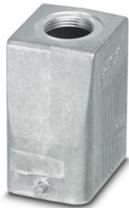
Tüllengehäuse B6, für Längsbügel, Material: Aluminiumdruckguss, seewasserbeständig, Kabelabgänge: 1, gerade, 1x M25, Höhe: 72 mm, Kabelverschraubung: ohne, Standard
