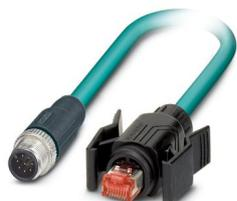
Netzwerkkabel, Ethernet CAT5 (1 GBit/s), 8-polig, PUR halogenfrei, wasserblau RAL 5021, Stecker gerade M12, Kodierung: A / IP67, auf Stecker gerade RJ45 Clipverriegelung / IP67, Kabellänge: 5 m
