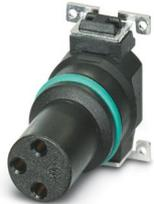
Kontaktträger, 3-polig, Buchse, gerade, M8, A-Kodierung, SMD-Reflow, dieser Artikel ist voraussichtlich ab 2027-Q1 nach RoHS II ohne Ausnahme 6c (Pb < 0,1 %) bleifrei, auf Anfrage ist eine bleifreie Alternative vorab möglich
