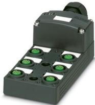
Verteilerbox, Anwendung: Standard, Anschlussart: M12-Buchse Kunststoff, Anzahl der Steckplätze: 6, Polzahl: 5, Kodierung: A, Steckplatzbelegung: doppelt, Statusanzeige: ja, PNP; Stammleitungsanschluss: Push-in- / Zugfederanschluss 180°, Schirmung: nein
