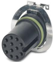
Kontaktrager, 12-polig, Buchse, gerade, M12, A-Kodierung, SMD-Reflow, dieser Artikel ist voraussichtlich ab 2027-Q1 nach RoHS II ohne Ausnahme 6c (Pb < 0,1 %) bleifrei, auf Anfrage ist eine bleifreie Alternative vorab moglich
