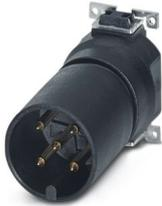
Kontaktträger, 5-polig, Stift, gerade, M12, A-Kodierung, SMD-Reflow, dieser Artikel ist voraussichtlich ab 2027-Q1 nach RoHS II ohne Ausnahme 6c (Pb < 0,1 %) bleifrei, auf Anfrage ist eine bleifreie Alternative vorab möglich
