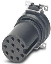
Kontaktträger, 12-polig, Buchse, gerade, M12, A-Kodierung, SMD-Reflow, dieser Artikel ist voraussichtlich ab 2027-Q1 nach RoHS II ohne Ausnahme 6c (Pb < 0,1 %) bleifrei, auf Anfrage ist eine bleifreie Alternative vorab möglich
