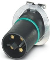
Kontaktträger, Leistung, 4-polig, Stift, gerade, M12, T-Kodierung, SMD-Reflow, dieser Artikel ist voraussichtlich ab 2027-Q1 nach RoHS II ohne Ausnahme 6c (Pb < 0,1 %) bleifrei, auf Anfrage ist eine bleifreie Alternative vorab möglich
