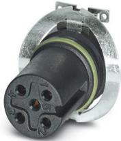
Kontaktträger, 4-polig, Buchse, gerade, M12, A-Kodierung, SMD-Reflow, dieser Artikel ist voraussichtlich ab 2027-Q1 nach RoHS II ohne Ausnahme 6c (Pb < 0,1 %) bleifrei, auf Anfrage ist eine bleifreie Alternative vorab möglich
