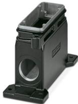
Sockelgehäuse B16, für Schraubverriegelung, Material: Aluminiumdruckguss, Kabelabgänge: 2, seitlich, 2x M40, Höhe: 111 mm, Kabelverschraubung: ohne, Schutzdeckel: nein, Bahnanwendungen, für erhöhte Umwelt- und EMV-Anforderungen, Serie HPR
