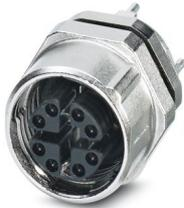
Gerätesteckverbinder Hinterwand, Ethernet CAT6<sub>A</sub>, 8-polig, Buchse, gerade, M12-SPEEDCON, X-Kodierung, THR-Lötanschluss, dieser Artikel ist voraussichtlich ab 2026-Q2 nach RoHS II ohne Ausnahme 6c (Pb < 0,1 %) bleifrei, auf Anfrage ist eine bleifreie Alternative vorab möglich
