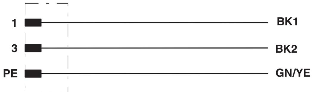
Kontaktbelegung des M12-Steckers
