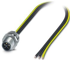
Gerätesteckverbinder Vorderwand, Leistung, 3-polig, Stift, gerade, M12-Standard, S-Kodierung, auf freies Leitungsende, Einzellitzen, Kabellänge: 0,5 m, 1,31 mm<sup>2</sup>, UL/cUL Schaltlitze, vergossen, dieser Artikel ist voraussichtlich ab 2026-Q1 nach RoHS II ohne Ausnahme 6c (Pb < 0,1 %) bleifrei, auf Anfrage ist eine bleifreie Alternative vorab möglich
