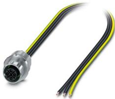
Gerätesteckverbinder Vorderwand, Leistung, 3-polig, Buchse, gerade, M12-Standard, S-Kodierung, auf freies Leitungsende, Einzellitzen, Kabellänge: 0,5 m, 1,31 mm<sup>2</sup>, UL/cUL Schaltlitze, vergossen, dieser Artikel ist voraussichtlich ab 2025-Q4 nach RoHS II ohne Ausnahme 6c (Pb < 0,1 %) bleifrei, auf Anfrage ist eine bleifreie Alternative vorab möglich
