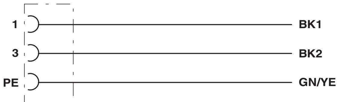
Kontaktbelegung der M12-Buchse
