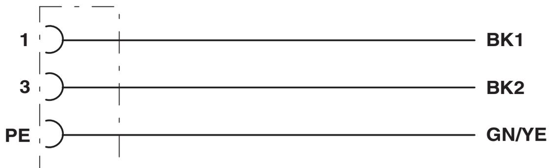
Kontaktbelegung der M12-Buchse
