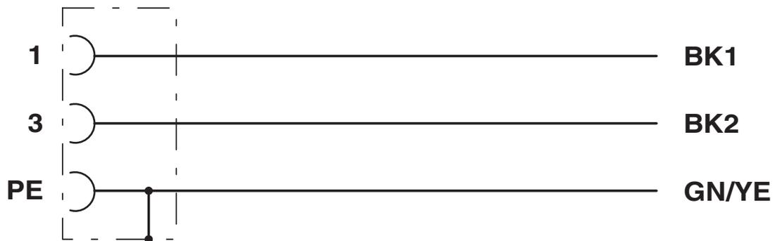
Kontaktbelegung der M12-Buchse
