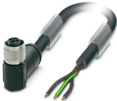
Powerleitung, 3-polig, PVC, schwarz, freies Leitungsende, auf Buchse gewinkelt M12, Kodierung: S, Kabellänge: 5 m, für Wechselstrom bis 16 A/690 V
