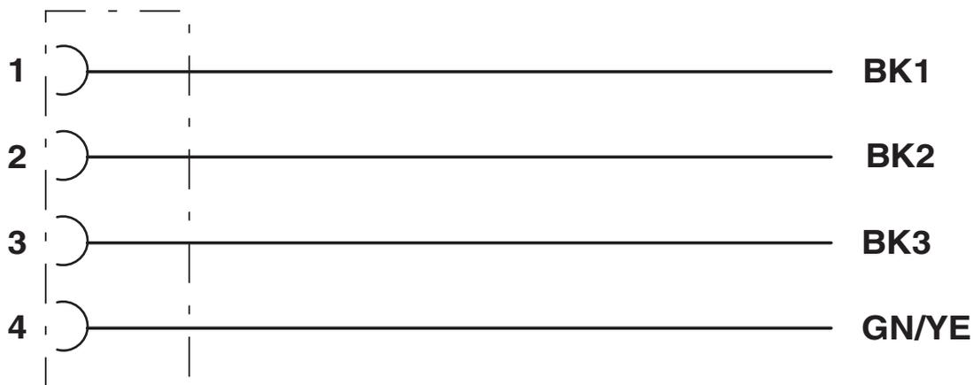
Kontaktbelegung der M12-Buchse
