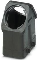
Tüllengehäuse B10, für Querbügel, Material: PA 6.6-FR, Kabelabgänge: 2, gerade/seitlich, Höhe: 87,5 mm, Kabelverschraubung: ohne, Schutzdeckel: nein, Standard
