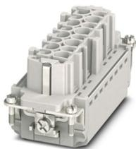
Kontakteinsatz, Polzahl: 16+PE, Baugröße: B16, Anzahl der Anschlüsse je Pol: 1, Buchse, Push-in-Anschluss, 500 V, 16 A, 0,14 mm<sup>2</sup> ... 2,5 mm<sup>2</sup>, Anwendung: Leistung
