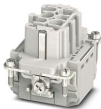
Kontakteinsatz, Polzahl: 6+PE, Baugröße: B6, Anzahl der Anschlüsse je Pol: 1, Buchse, Push-in-Anschluss, 500 V, 16 A, 0,14 mm<sup>2</sup> ... 2,5 mm<sup>2</sup>, Anwendung: Leistung
