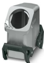
HEAVYCON EVO-Tüllegehäuse, EMV-Ausführung, ohne Pulverlackierung, mit Bajonettflansch für die EVO-Verschraubung, B16, mit Querbügel, Höhe 88 mm, ohne EVO-Verschraubung.
