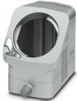
HEAVYCON EVO-Tüllegehäuse, EMV-Ausführung, ohne Pulverlackierung, mit Bajonettflansch für die EVO-Verschraubung, B10, für Längsbügel, Höhe 64 mm, ohne EVO-Verschraubung.
