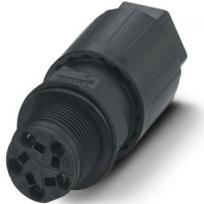
QUICKON-Wanddurchführung, schwarz, 4+PE-polig, 1,0 mm<sup>2</sup> ... 2,5 mm<sup>2</sup> / 690 V / 20 A, mit QUICKON-Mutter, für Kabeldurchmesser 9 mm ... 16 mm, mit Push-in-Federkraftanschluss.
