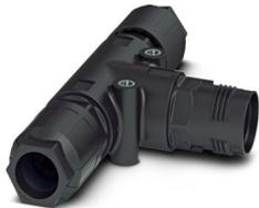
QUICKON T-Verteiler, schwarz, 4+PE-polig, 2,5 mm<sup>2</sup> ... 6,0 mm<sup>2</sup> / 690 V / 40 A, für Kabeldurchmesser 9 mm ... 14 mm, mit zwei Quickon-Muttern
