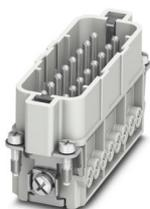
Kontakteinsatz, Polzahl: 16+PE, Baugröße: D25, Anzahl der Anschlüsse je Pol: 1, Stift, Schraubanschluss, 250 V, 16 A, 0,5 mm<sup>2</sup> ... 2,5 mm<sup>2</sup>
