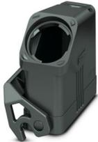
Kupplungsgehäuse D25, mit Längsbügel, Material: PA 6.6-FR, Kabelabgänge: 1, gerade/seitlich, Höhe: 70 mm, Kabelverschraubung: ohne, Standard
