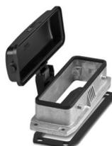
Anbaugehäuse B24, für Querbügel, Material: Aluminiumdruckguss, seewasserbeständig, Material Schutzdeckel: PC, Höhe: 30,5 mm, Kabelverschraubung: ohne, Schutzdeckel: ja, Standard, mit Flachdichtung
