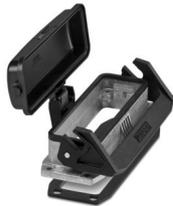
Anbaugehäuse B24, mit Längsbügel, Material: Aluminiumdruckguss, seewasserbeständig, Material Schutzdeckel: PC, Höhe: 30,5 mm, Kabelverschraubung: ohne, Schutzdeckel: ja, Standard, mit Flachdichtung
