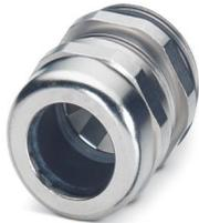
Kabelverschraubung, Material Verschraubung: Messing, vernickelt, Anwendung: EMV, Kabelaußendurchmesser 9 mm ... 13 mm, Schirmung: ja, Anschlussgewinde: M20 x 1,5, Farbe: silberfarben, mit O-Ring
