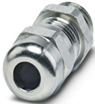
Kabelverschraubung, Material Verschraubung: Messing, vernickelt, Anwendung: EMV, Kabelaußendurchmesser 4 mm ... 6,5 mm, Schirmung: ja, Anschlussgewinde: M12 x 1,5, Farbe: silberfarben, mit O-Ring
