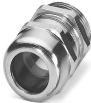
Kabelverschraubung, Material Verschraubung: Messing, vernickelt, Anwendung: Standard, Kabelaußendurchmesser 4 mm ... 8 mm, Schirmung: nein, Anschlussgewinde: Pg9, Farbe: silberfarben, mit O-Ring
