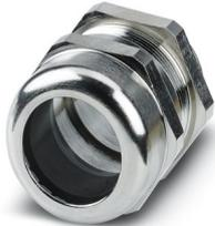
Kabelverschraubung, Material Verschraubung: Messing, vernickelt, Anwendung: Standard, Kabelaußendurchmesser 27 mm ... 38 mm, Schirmung: nein, Anschlussgewinde: M50 x 1,5, Farbe: silberfarben, mit O-Ring
