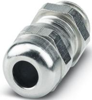
Kabelverschraubung, Material Verschraubung: Messing, vernickelt, Anwendung: Standard, Kabelaußendurchmesser 3 mm ... 6,5 mm, Schirmung: nein, Anschlussgewinde: M12 x 1,5, Farbe: silberfarben, mit O-Ring
