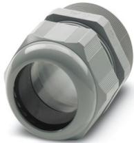
Kabelverschraubung, Material Verschraubung: PA, Anwendung: Standard, Kabelaußendurchmesser 34 mm ... 44 mm, Schirmung: nein, Anschlussgewinde: M63 x 1,5, Farbe: silbergrau RAL 7001
