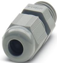
Kabelverschraubung, Material Verschraubung: PA, Anwendung: Standard, Kabelaußendurchmesser 5 mm ... 10 mm, Schirmung: nein, Anschlussgewinde: M16 x 1,5, Farbe: silbergrau RAL 7001
